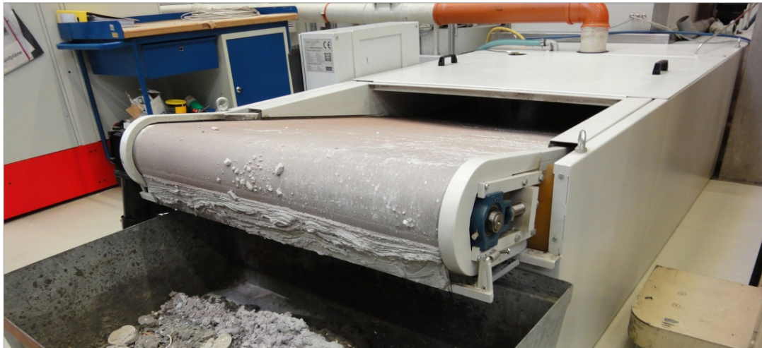
Bild 8: Selbstreinigender MAXFLOW-Bandfilter für Filterfeinheit \leq 40 \mu\text{m} .
