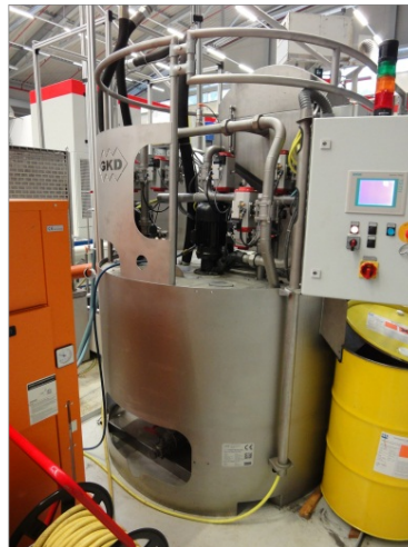
Bild 7: Bei der geforderten Filterfeinheit von \leq 5 \mu\text{m} beträgt die Filterleistung 200 Liter pro Minute.
