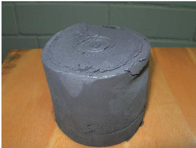
Bild 9: MAXFLOW ermöglicht einen sortenreinen Austrag der zurückgehaltenen Feststoffe als Brikkett.
