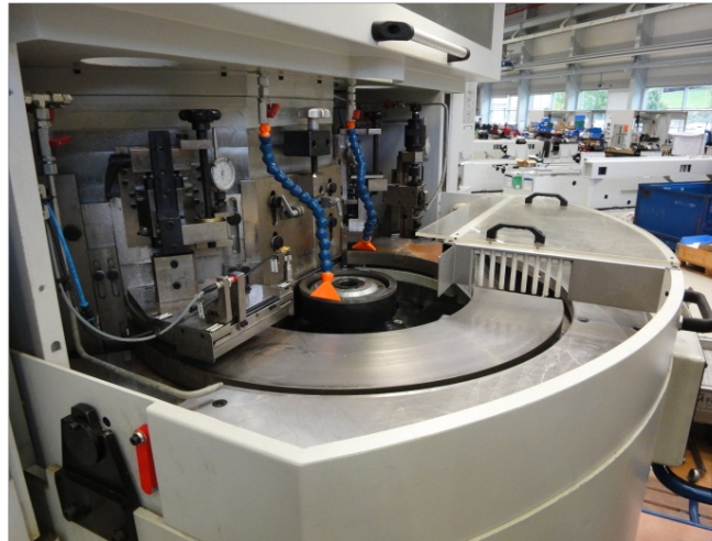
Bild 5: Die Supfina Doppelseitenplanschleifanlagen vom Typ Planet überzeugen durch hohe Zuverlässigkeit.
