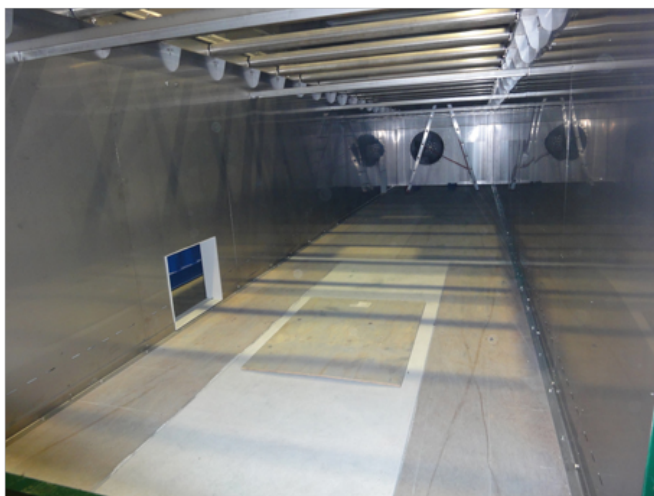
Bild 5: Die Container von NEWeco-tec werden innen komplett mit Edelstahl Rostfrei ausgekleidet.
