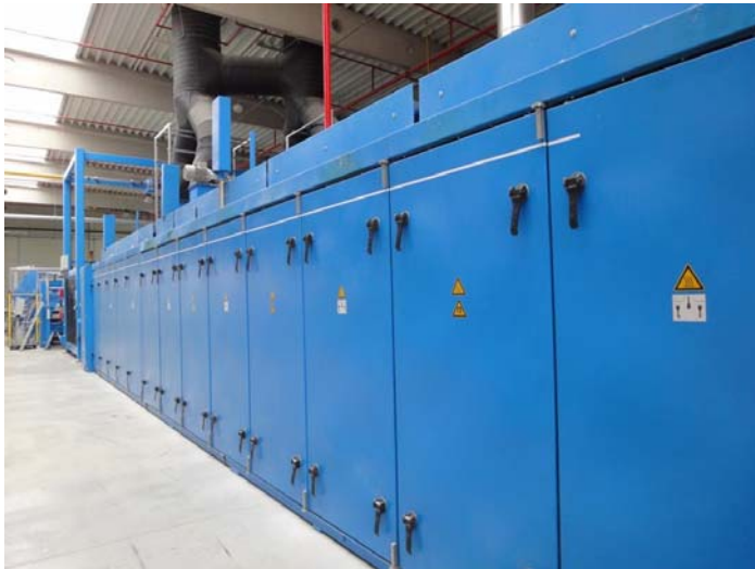
Bild 9: 14 Meter langer Doppelbandofen
