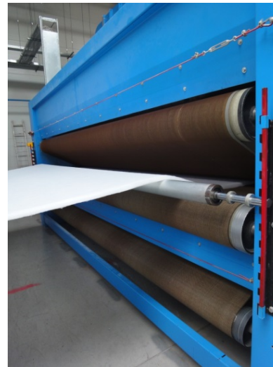
Bild 7-8: Maßgeschneidertes Trocknerband von GKD erfüllt die besonderen Anforderungen der dicken Dämmprodukte.
