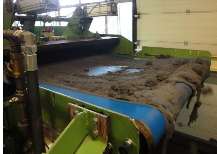
Bild 6: Die glatte Oberfläche der spezifischen Gewebekonstruktion aus Polyestermonofilien gewährleistet einen guten Kuchenabwurf.
