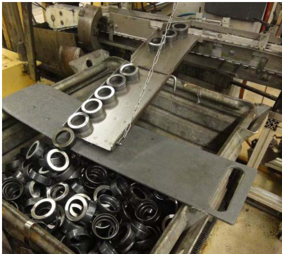
Bild 7: Transport der Ringe über Laufbahnen
