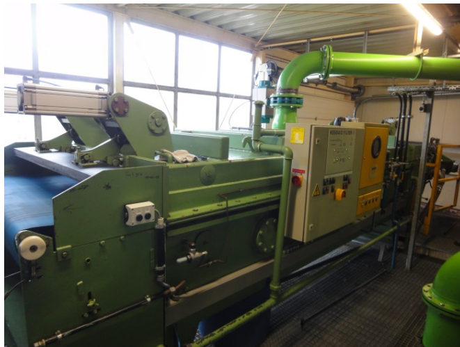
Bild 3: In der Zentralfilteranlage zur Fertigung von Wälzlagern und Hightech-Komponenten bei Schaeffler in Schweinfurt ersetzt ein Polyesterfilterband vom Typ VACUBELT® 3354 der GKD das bisher eingesetzte Kunststoffband.
