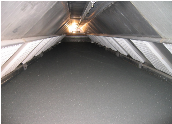
Bild 3: Luftdurchlässig, quer- und formstabil gewährleisteten Trocknerbänder von GKD eine ebenso kostensparende wie umweltschonende Klärschlamm-trocknung in Hoch- oder Niedertemperaturtrocknern.
