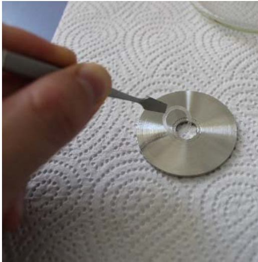
Photo 10 : Insertion du joint en silicone dans l'encoche de la face arrière du disque inox supérieur. Exercer une pression avec le doigt.
