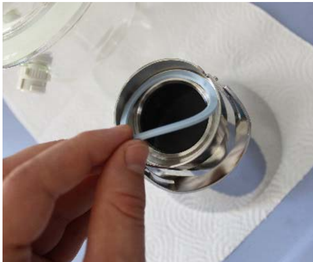
Photo 13 : Insertion du joint épais dans l'encoche de la face inférieure de la trémie (élément filtrant).
