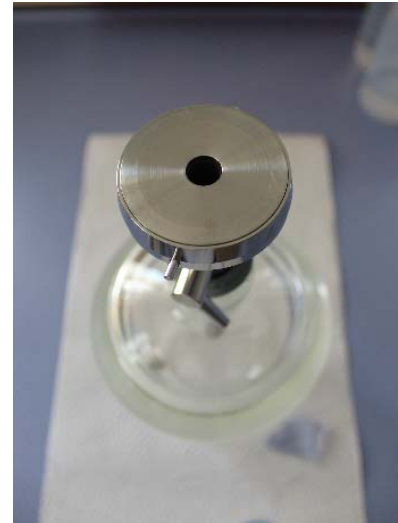
Photo 12 : Support de l'appareil de filtration avec creuset emboîté.
