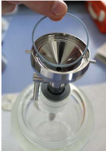
Photo 5 : Insertion du joint fin dans l'appareillage de filtration en inox.
