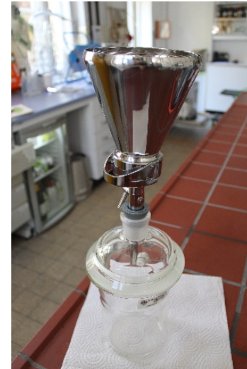
Photo 15 : Fermeture de l'appareil de filtration à l'aide des fermetures à crochets existantes.
