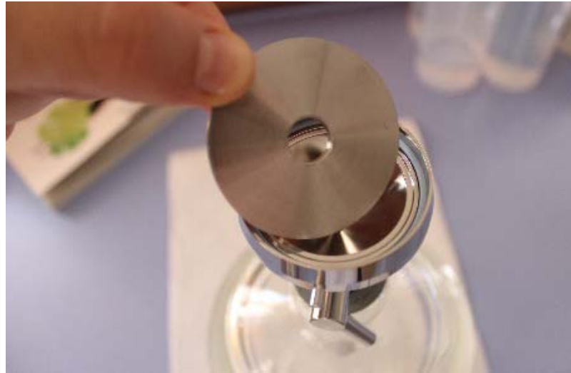
Photo 6 : Insertion du disque en inox inférieur ; petit décrochement pour installer ensuite le creuset.
