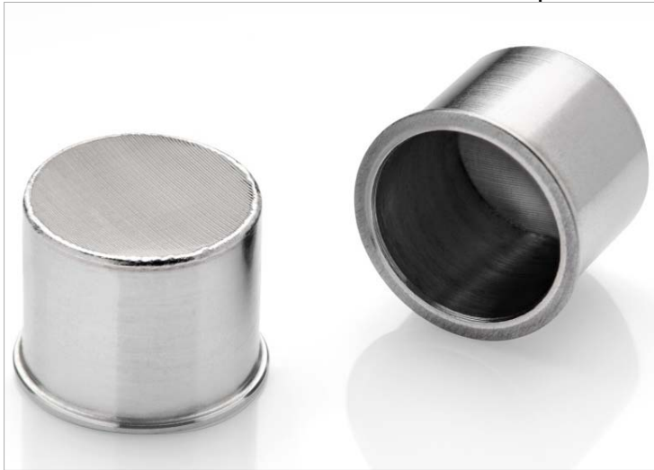
Photo 1 : Le creuset filtrant microlitrique, mis au point par BAM, UBA et GKD pour la détermination de la teneur massique en microplastiques dans les fluides environnementaux, permet des analyses à la fois rapides et fiables d'échantillons complexes.
