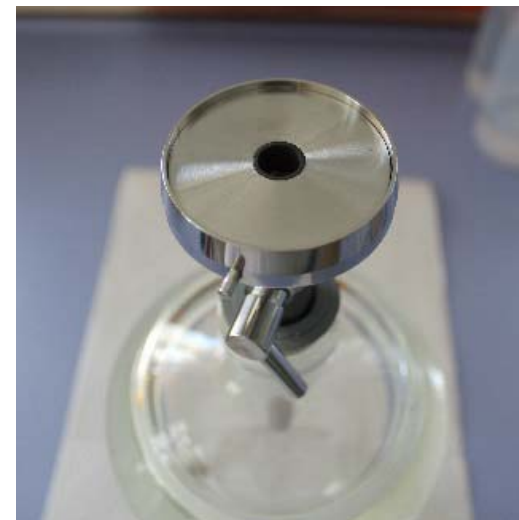
Photo 9 : Support de l'appareil de filtration avec creuset. Le creuset doit affleurer.
