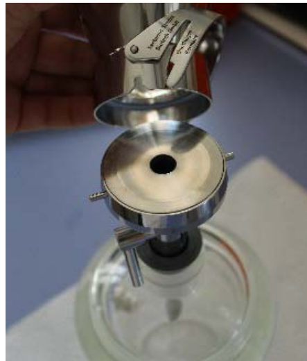
Photo 14 : Mise en place de l'élément filtrant, bien droit, sur le support, dans les rainures prévues à cet effet.
