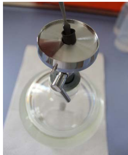
Photo 8 : Insertion du creuset filtrant microlitrique dans l'orifice du disque inox inférieur. Le rebord du creuset doit venir en appui dans le petit décrochement, sur tout le pourtour.
