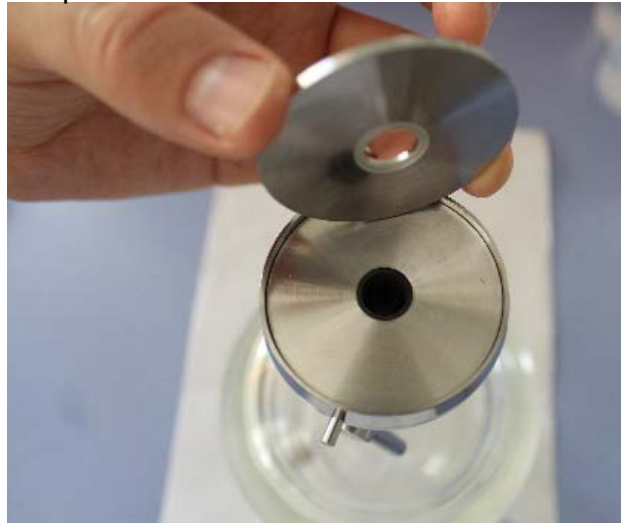
Photo 11 : Mise en place du disque inox supérieur, avec le joint tourné vers le disque inox inférieur.
