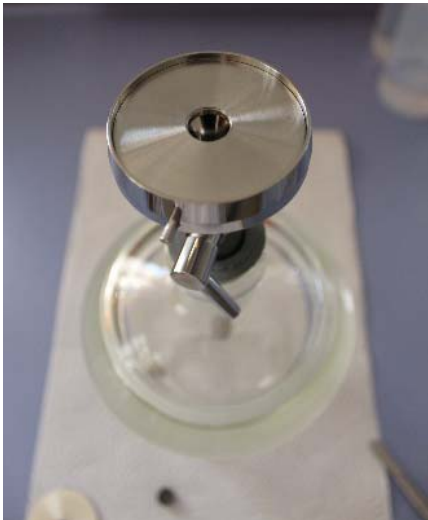
Photo 7 : Support de l'appareil de filtration, sans creuset.
