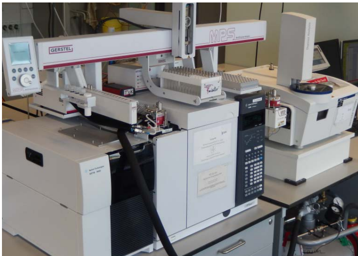
Photo 3 : Le procédé TED-GC/MS permet de déterminer rapidement et fidèlement les teneurs en masse.
