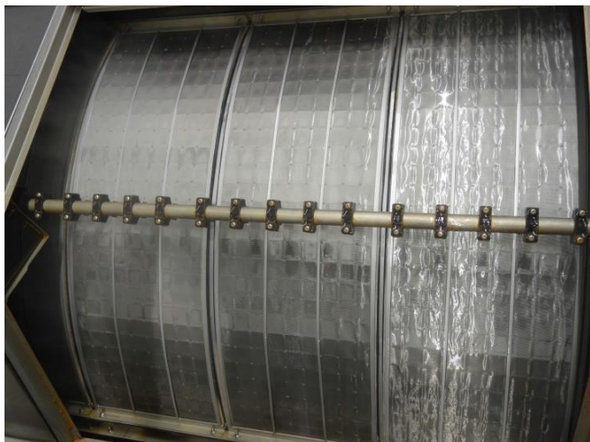
Bild 3: Porometric-Gewebe von GKD bewährt sich in Trommelfiltern zur mechanische Wasserreinigung – wie hier in der Indoor-Lachszucht bei Swiss Alpine Fish AG.
