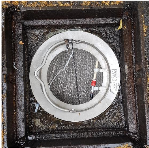
Bild 9:: Auf jedem Sieb wurde eine plissierte Geweberonde mit jeweils analoger Porengröße platziert, die durch ihre dreidimensionale Struktur als Vorfilter dient, um die Grobstoffe zurückzuhalten.
