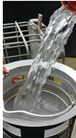
Bild 8: Ein Füllstandsmesser meldet einen drohenden Überlauf und verbessert somit neben der Straßensicherheit auch die Validität der Probenahme.
