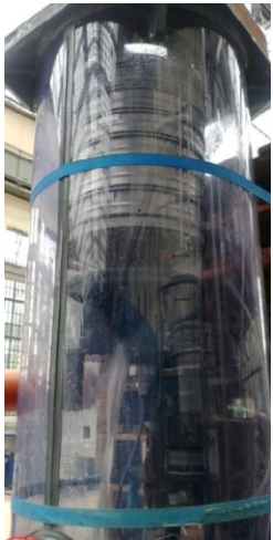
Bild 3: Im Teststand der TU Berlin zeigte sich schnell, dass die prinzipielle hydraulische Auslegung des Korbs stimmte.
