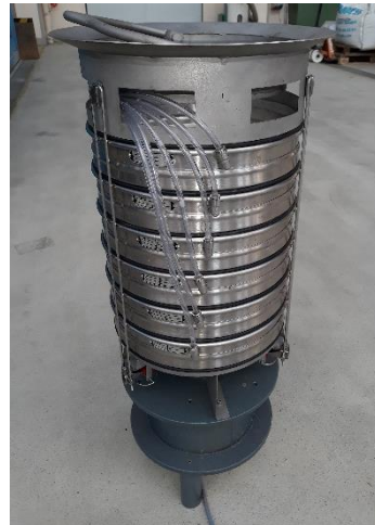
Bild 4: In Testreihen entwickelten die Filterexperten von GKD gemeinsam mit den Forschern der TU eine seitliche Entlüftung des Probenahmekorbs.
